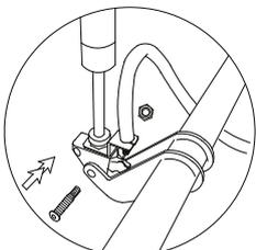
4. Используя винт (5) и гайку (7) присоедините нижнюю сторону газ-лифта (D) к креплению столешницы (E)
