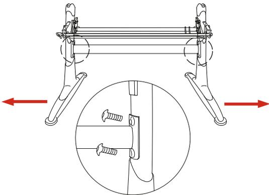
2. Используя винты (2) присоедините соединительный кронштейн (F) к опорам (C). Затяните винты.
