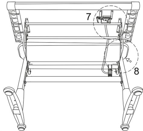
7. Присоедините столешницу (A) к креплению столешницы (E) и присоедините ручку подъема газ-лифта (D) к столешнице (A) используя винты (1)
