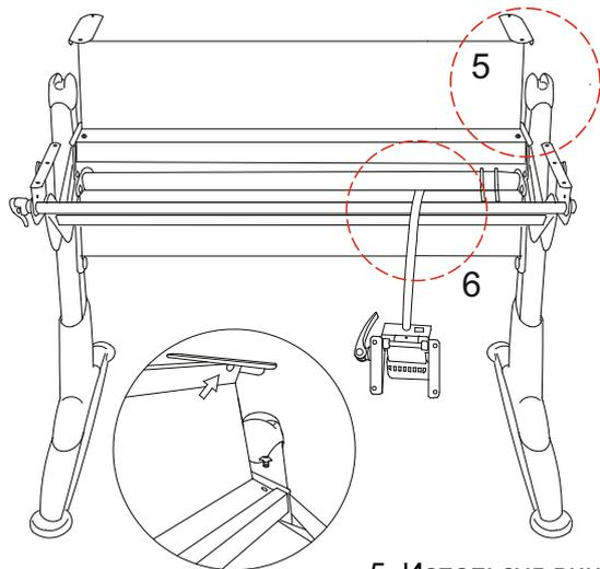
1. Вставьте крючок на креплении столешницы (E) в отверстие на опоре (C) и прикрепите используя винты (6). Затяните винты.
