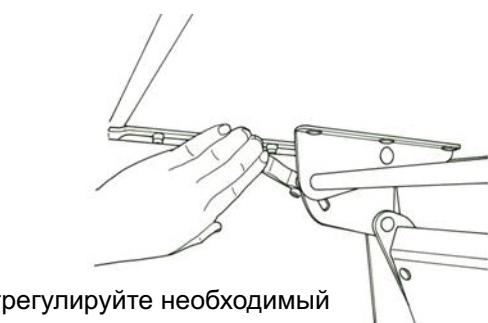
3. Перед регулировкой угла наклона разблокируйте ручку фиксации угла наклона.
